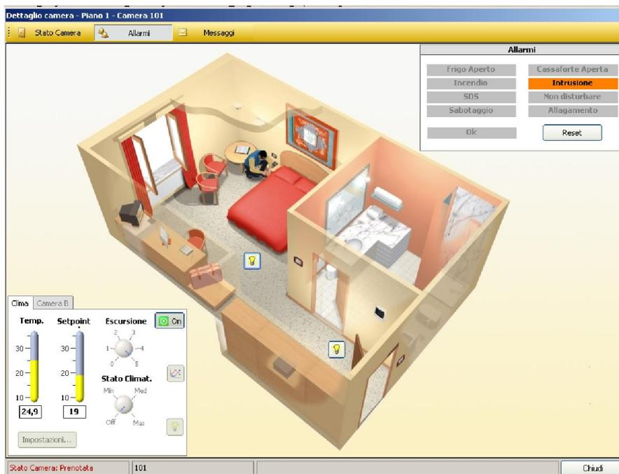
**求助：**拉动浴室的拉绳开关或者按下客房里的报警按钮都可以请求帮助，客房外面会响起铃声，监控PC机上会出现可视信号。此类警报发出后，开门不需要任何房卡。
