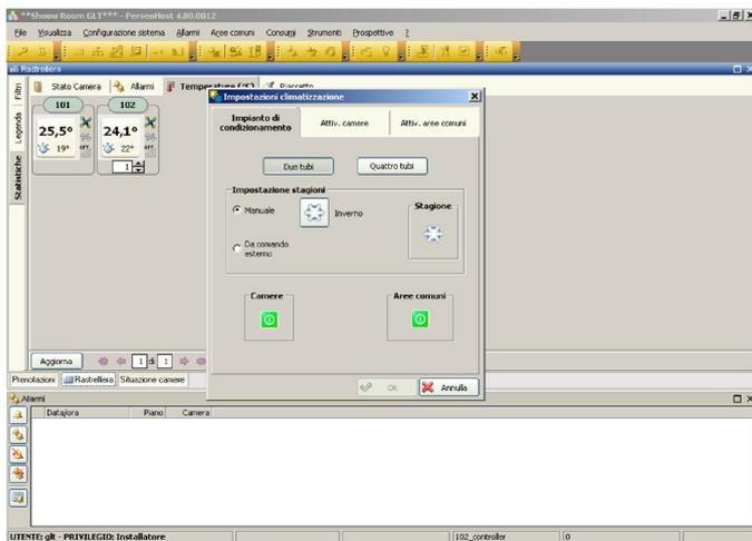
控制室内的模块掌握正在使用空调的客房数量，空调的使用率确定后，锅炉、压缩机和空气处理装置的运转会产生相应变化，从而起到节能和节省管理成本的作用。
